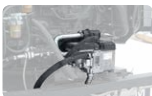
Предпусковой автономный подогреватель ОЖ (WEBASTO)
