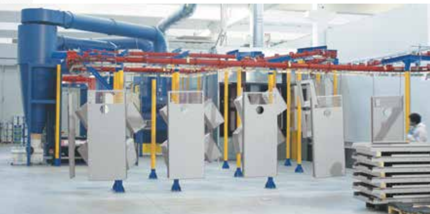
Передовая линия окраски: фосфатное обезжиривание, порошковое напыление, сушильные камеры
