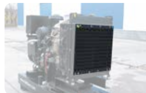
Защитная решётка на радиаторе
